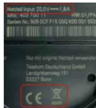
如圖所示 Netzteil Input即為此產品所需輸入的電源；CE為符合歐盟安規要求之標示；垃圾桶劃叉的符號則為提醒使用者，此產品廢棄時不可直接投入垃圾桶，而應依循回收途徑處理
